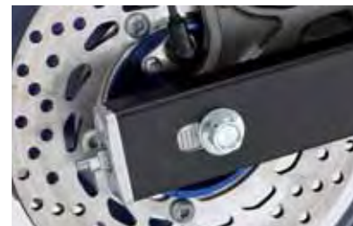
チェーンプラーは整備性の良い内側インジケーター 表示を採用
