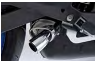
マスの集中化を実現し、心地良いサウンドを奏でる 4-2-1ミッドシップマフラー
