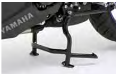
日常のメンテナンスに便利なセンタースタンドを装備 ※XJ6 DIVERSION/ABS、XJ6 DIVERSION F/ABS に装備
